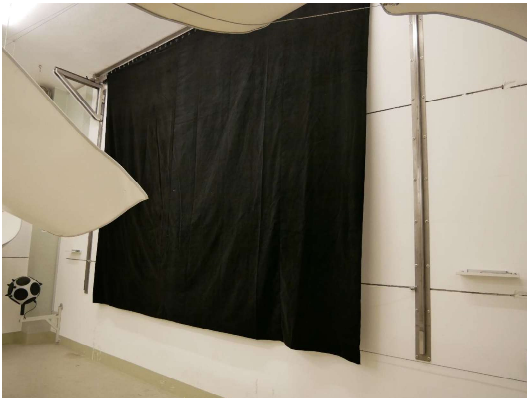
Abbildung B.2. Glatte Prüfanordnung im Hallraum (diagonale Ansicht).
