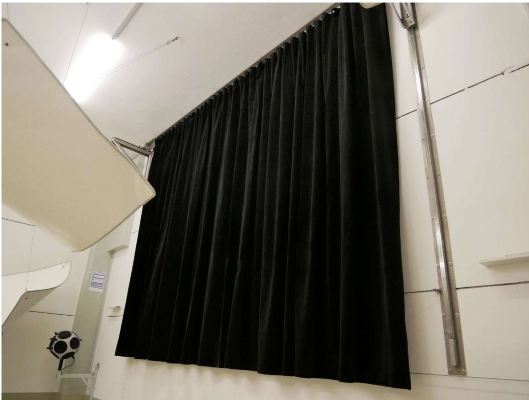
Abbildung B.4. Geraffte Prüfanordnung im Hallraum (diagonale Ansicht).
