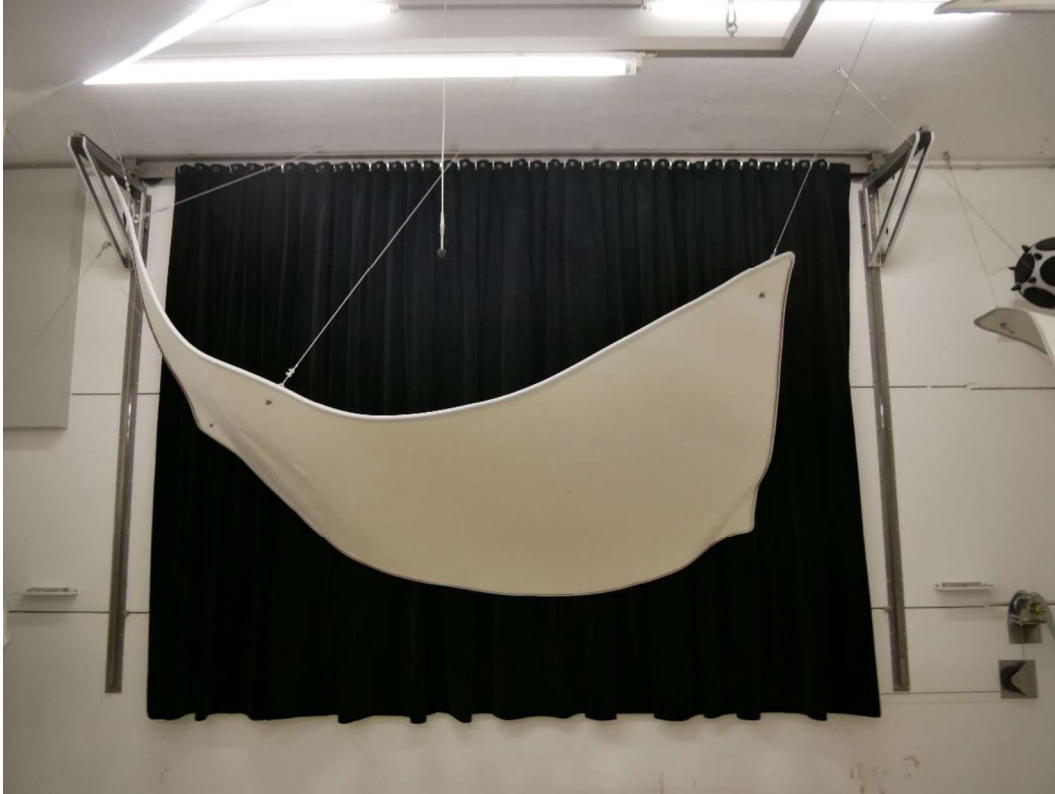
Abbildung B.3. Geraffte Prüfanordnung im Hallraum (frontale Ansicht).
