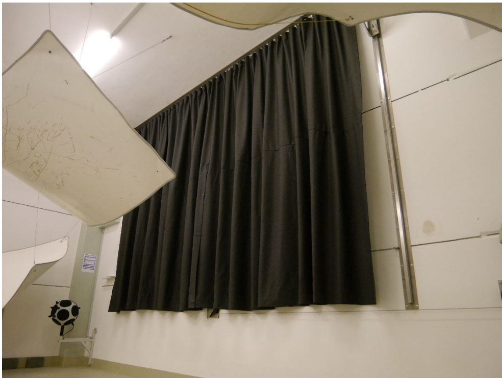
Abbildung B.4. Vorhang gerafft hängend im Hallraum, 100 % Stoffzugabe: Schrägansicht.
