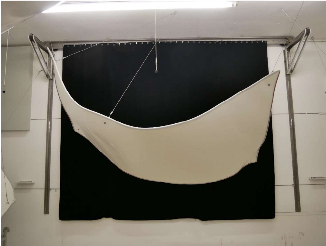
Abbildung B.1. Glatte Prüfanordnung im Hallraum (frontale Ansicht).
