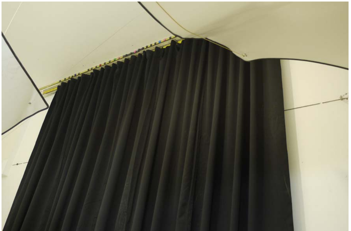
Foto B.2 Prüfaufbau im Hallraum – Gewebe mit Faltenzugabe (Aufbau 2)
