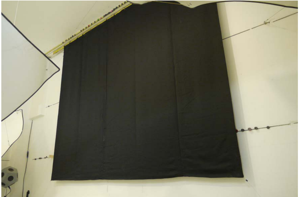
Foto B.1 Prüfaufbau im Hallraum – Gewebe glatt hängend (Aufbau 1)
